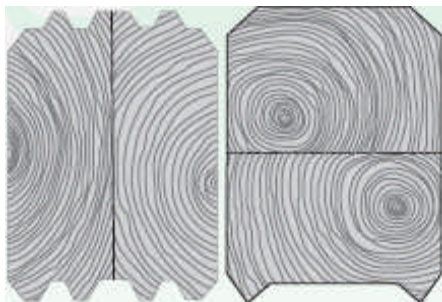
Bild 3. Exempel på tvärsnitt av vågrätt och lodrätt limmad lamellstock.
